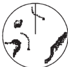
(a) Sillages des cibles en mode Vrai (absence de bavure pour les cibles stationnaires)
