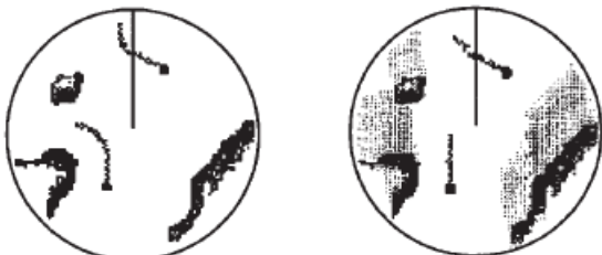
(a) Sillages des cibles en mode Vrai (absence de bavure pour les cibles stationnaires) (b) Sillages des cibles en mode relatif (Déplacements relatifs des cibles par rapport au bateau)
