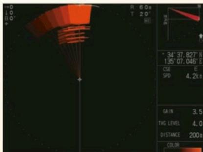
Le mode A-SCOPE met en évidence l'écho en une seule couleur. Son opacité est relative à la force de l'écho, mettant en évidence la force de l'écho. Celui-ci est plus facile à identifier.
